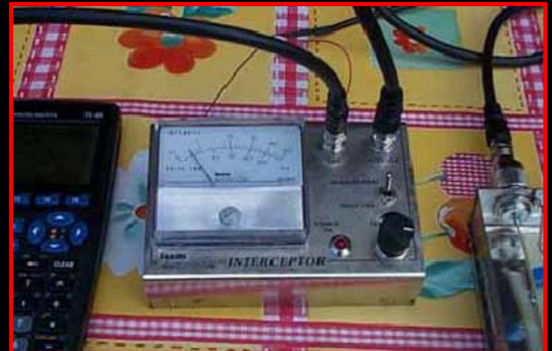
Il Sat Finder usato come ricevitore del radiometro; si noti la manopola che permette di modificare il guadagno.
